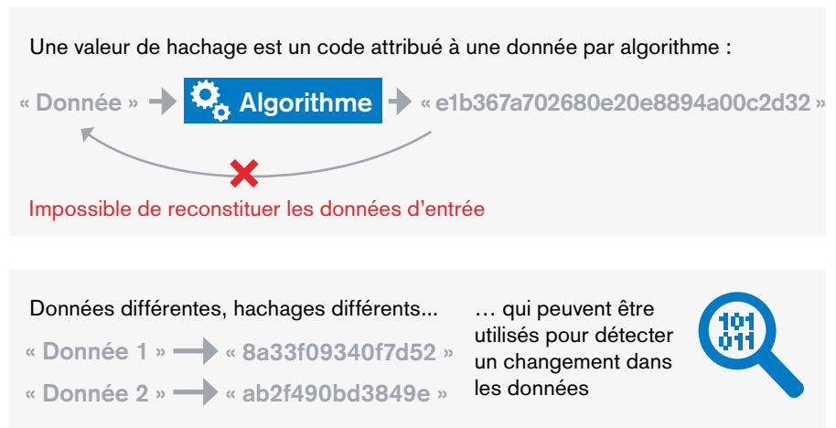
Graphique 3 : Les bases de la chaîne de blocs : le hachage cryptographique
