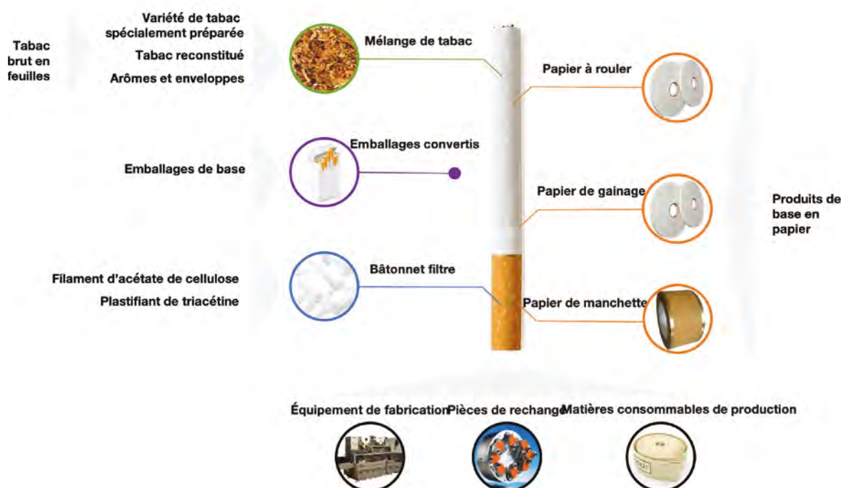
Diagramme 1 - Principaux intrants nécessaires pour la fabrication d'un paquet de cigarettes
